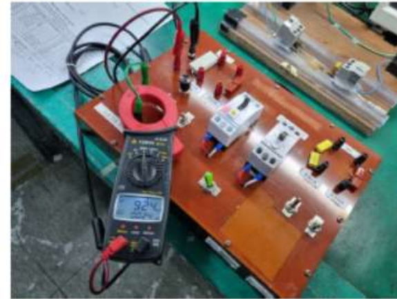
[ IGR-32i3 시험 사진 : 적색 LED 점등 ]
