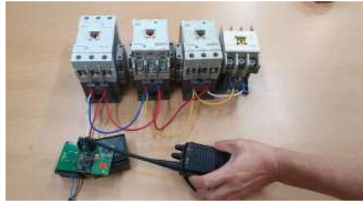
코일-로커 무전기 발신 내성시험 ( 30cm 근접시험 )
